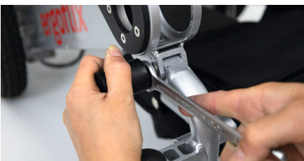
Abbildung 9: Arretieren des Adapters
