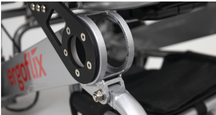
Figure 1 : retrait du support de batterie
